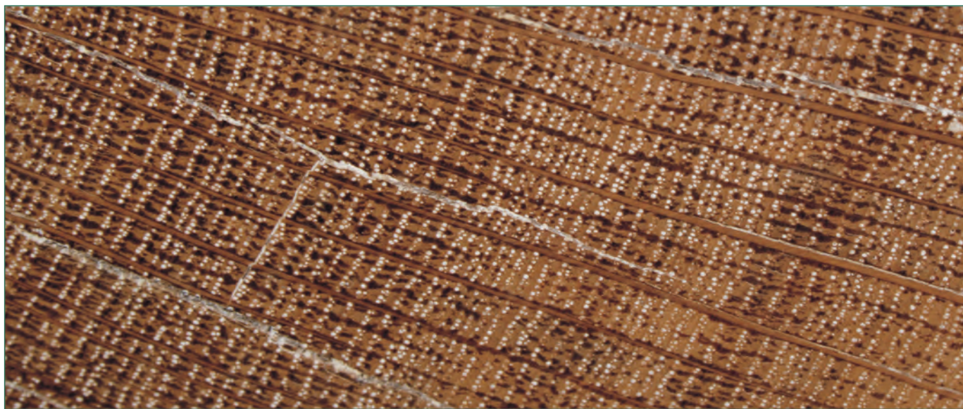
Fig. 47. Fragmento de madeira de carballo preparada para a visualización e medición dos aneis.
