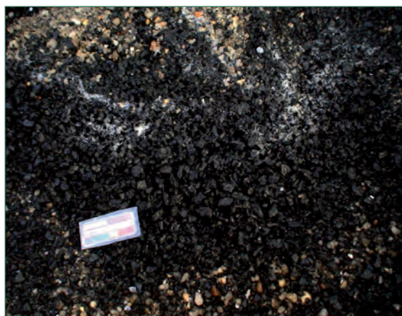
Fig. 36. Residuo resultante do cribado en auga dun sedimento cun importante compoñente orgánico, malla de 5 e 2 mm.
